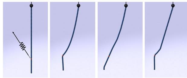
(a) Point d'action du ressort (b) 50 liaisons actives (c) 5 liaisons actives sans l'algorithme (d) 5 liaisons actives avec l'algorithme
